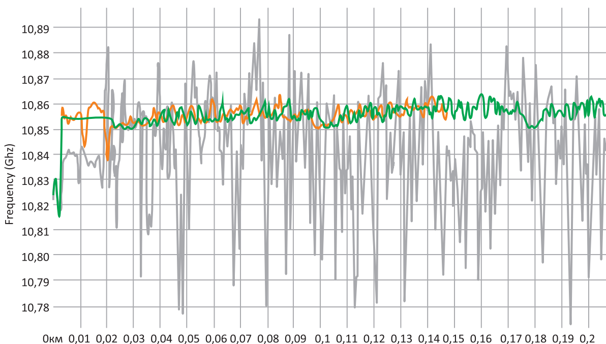
Рис. 4. Влияние материала покрытия на частоту вынужденного рассеяния Мандельштама-Бриллюэна в волокне: зелёная кривая – исходное волокно; оранжевая кривая – ОВ в покрытии из полиакрилата; серая кривая – ОВ в покрытии из кремнийорганической резины
