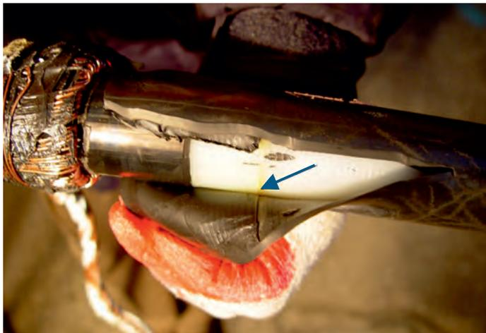
Рис. 11. Следы разрядов на поверхности кабеля соответствуют краю наложения манжеты из герметика В-3 (показаны стрелкой)
