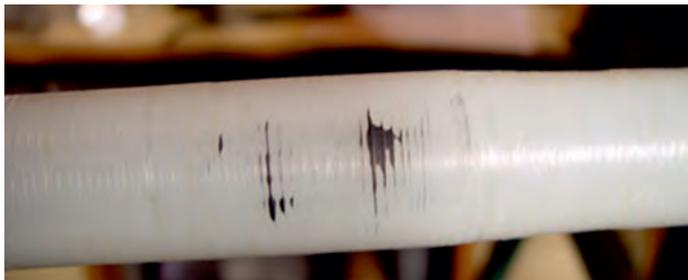
Рис. 8. Остатки материала экрана на поверхности изоляции
