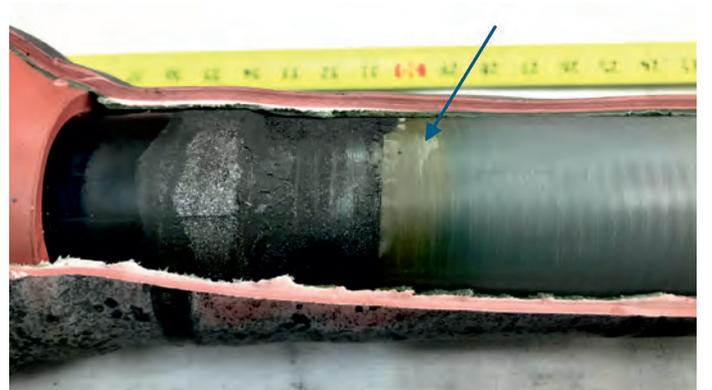
Рис. 6. Следы частичных разрядов на поверхности изоляции кабеля (потемнение изоляции показано стрелкой)
