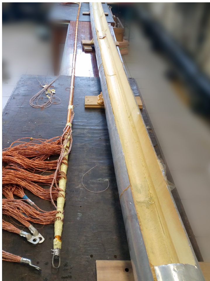
Рис. 4. Макет триаксиального ВТСП-кабеля перед установкой в криостат
