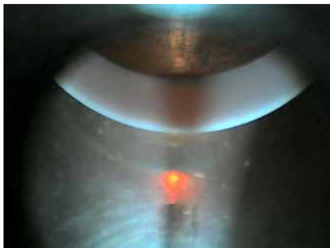
Рис. 2. Изображение образца фторопласта-4 в измерительном зазоре резонатора
