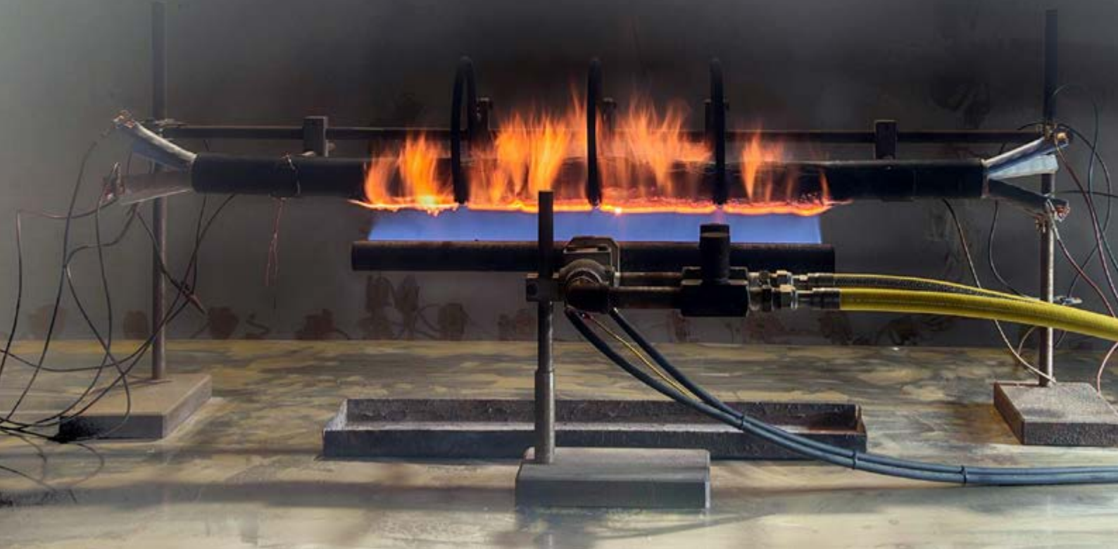
Рис. 2. Испытание на сохранение работоспособности в условиях воздействия пламени
