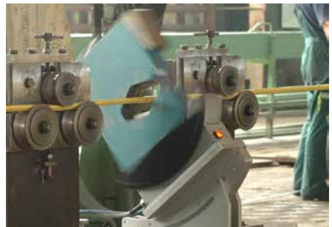
Рис. 3. Двухосевая лазерная измерительная головка с системой «качания» для измерения изолированного сектора
