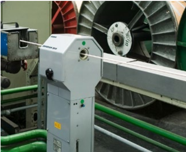
Рис. 2. Контроль качества при производстве автомобильных и монтажных проводов, а также кабелей связи (CENTERVIEW 2000)
