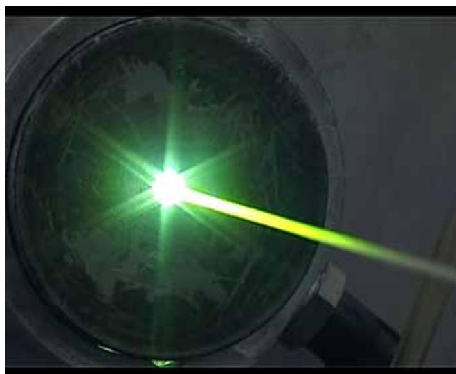
Рис. 3. Узел ультрафиолетового отверждения пропитанного смолой пучка стекловолокна
