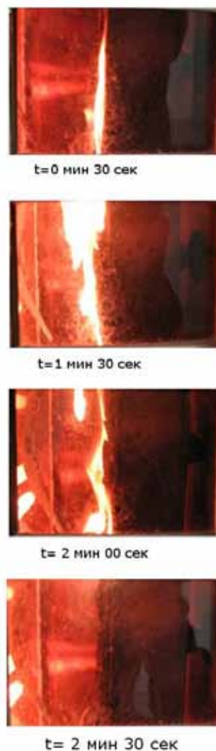
Рис. 6. Особенности горения пластикатов типа «ПП»
