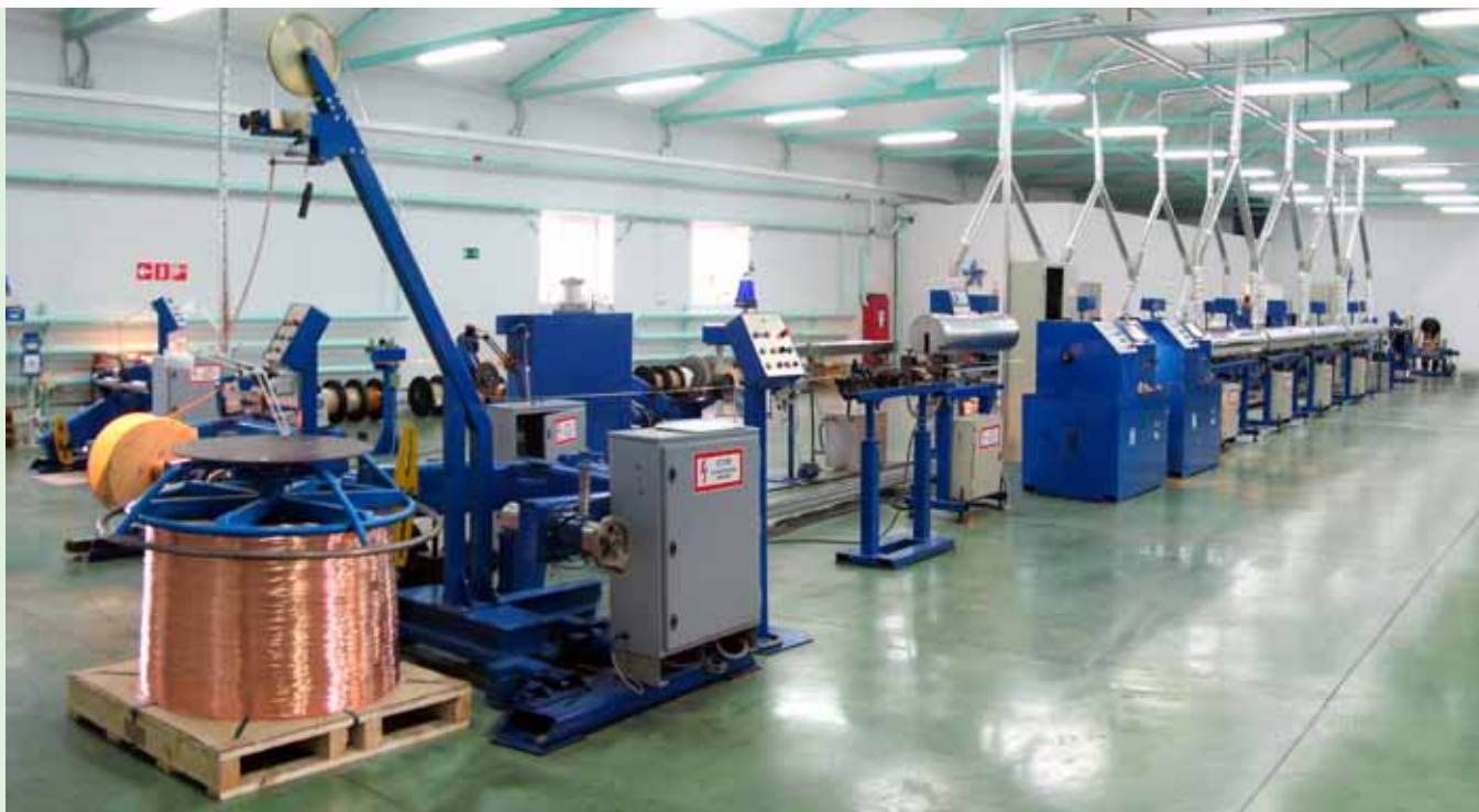
Рис. 7. Линия для производства проводов со спекаемой изоляцией на основе полиимидно-фторопластовых пленок
