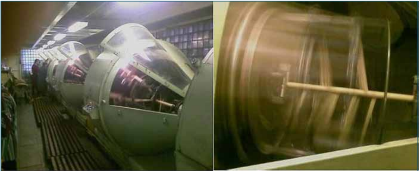
Рис. 7. Технологическая операция наложения изоляции. Изготовленные жилы были упакованы, отправлены в Пермь на завод «Камский кабель». С участием специалистов и использованием оснастки ВНИИКП проведено изолирование всех фаз кабеля
