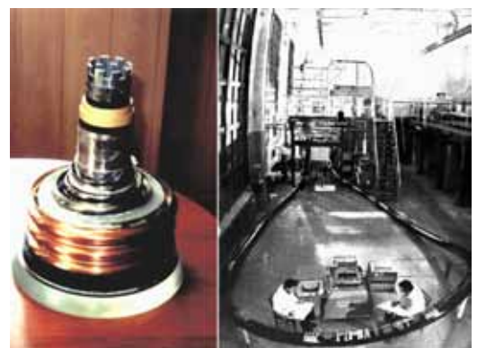
Рис. 2. Сверхпроводящий силовой кабель на основе низкотемпературных сверхпроводников, разработанный в 70-х годах прошлого столетия с участием ВНИИКП. Слева – модель кабеля. Справа – кабель в гибком криостате длиной 50 м и током 12500 А
