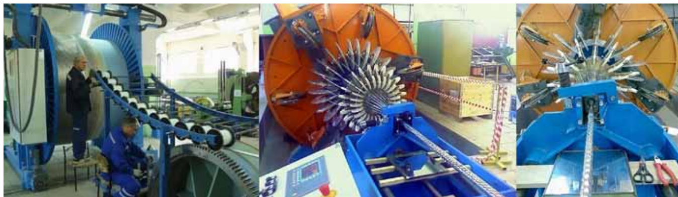
Рис. 6. Технологические операции наложения повивов сверхпроводящих лент со строго заданными шагами и направлениями скрутки. Были уложены по два повива на жилы каждой из трех фаз кабеля, а после наложения изоляции и сверхпроводящий экран. Длины фаз ~ 210 м каждая. Укладка велась в строгом соответствии с расчетами
