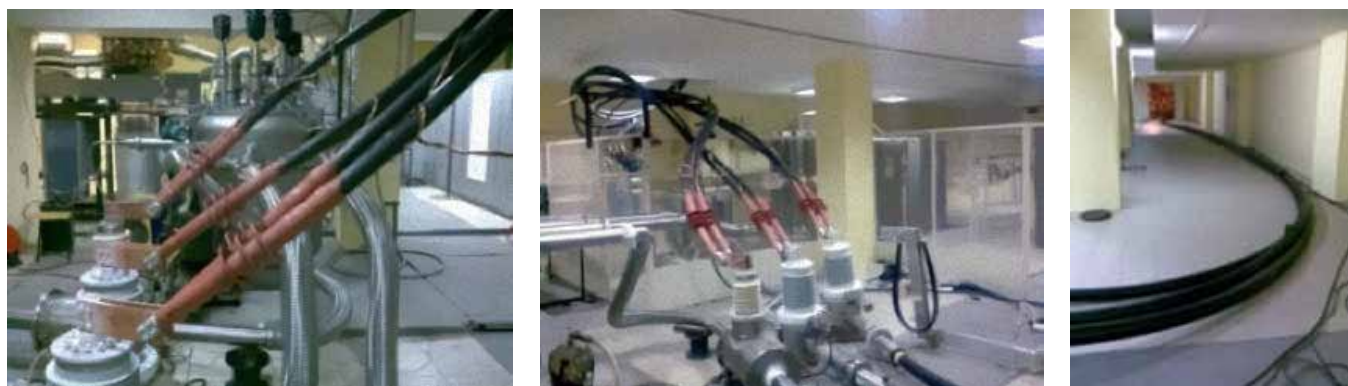
Рис. 4. Экспериментальный ВТСП силовой кабель, три фазы по 30 м. Токовводы, подсоединенные к кабелю и электрической и криогенной системам (слева), и кабель, установленный на экспериментальном стенде (справа)
