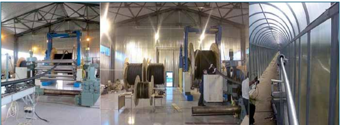
Рис. 8. Технологические операции затягивания кабеля в длинномерные криостаты. На полигоне для джекетирувания ВНИИКП в ИФВЭ, г. Протвино, проведено затягивание кабеля в криостаты
