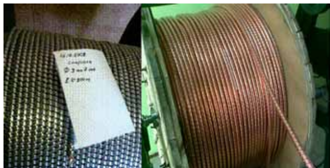
Рис. 5. Внешний вид формера. Было изготовлено 660 м формера (центрального несущего элемента)
