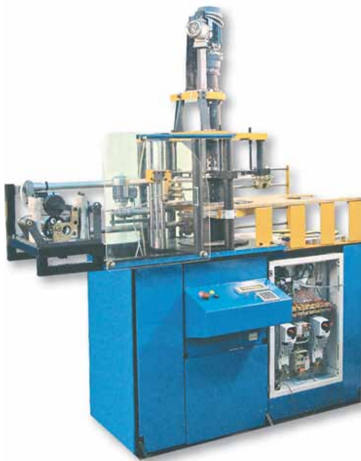
Рис.1. Изготовленная двухпозиционная автоматизированная бухтовочная машина (бухтовщик)
