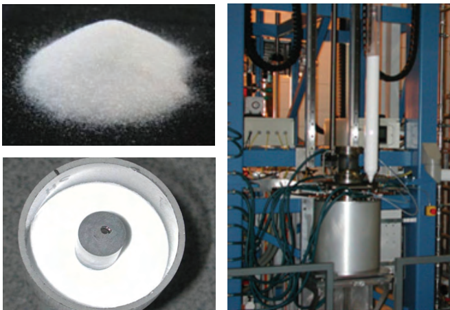
Рис. 8. Вытяжка заготовки, изготовленной по технологии SAND
