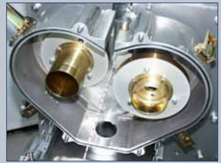
Рис. 9. Маркирующая головка с вращающимися маркирующими барабанами
