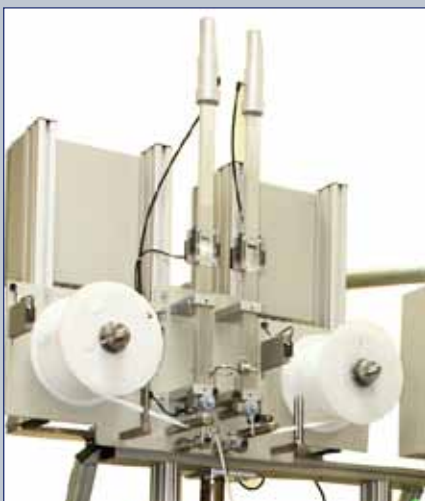
Рис. 8. Тандемное высокоскоростное отдающее устройство для красящей ленты
