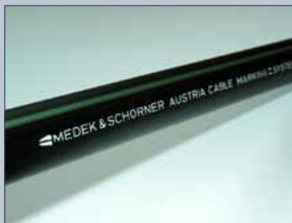
Рис. 5. Кабель, маркированный методом тиснения через цветную ленту
