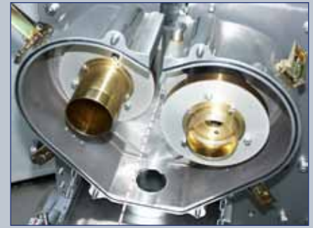
Рис. 9. Маркирующая головка с вращающимися маркирующими барабанами
