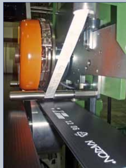
Рис. 7. Маркирующий ролик с нагреваемыми печатными штампами и красящая лента
