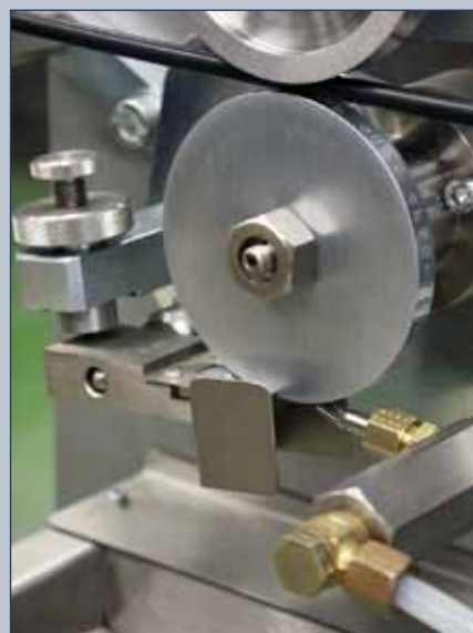
Рис. 3. Печатный ролик с форсункой для подачи краски и скребком для удаления излишков краски
