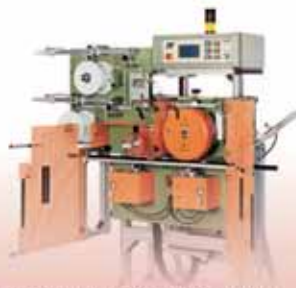
Высокопроизводительная установка для нанесения маркировки метровой длины на горячую фольгу
