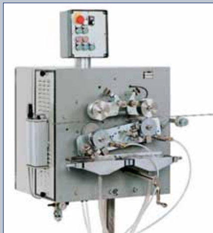
Рис. 4. Высокоскоростной маркировщик глубокой печати с тандемной маркирующей головкой
