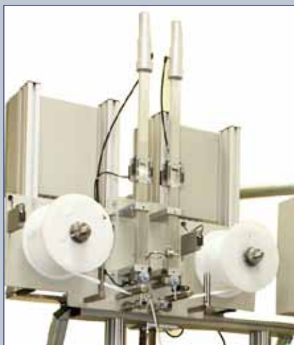
Рис. 8. Тандемное высокоскоростное отдающее устройство для красящей ленты
