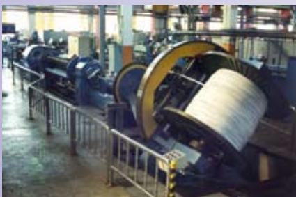
Скрутка жилы силового кабеля на крутильной машине Drum Twister фирмы «Proton» (Великобритания)
