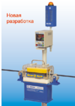
«Корона-ЗАСИ» Звучающие аппараты сухих испытаний. Синусоида (0,5...1,2) кГц. Амплитуда (0,5...40) кВ. Диаметр кабеля до 30 мм.
