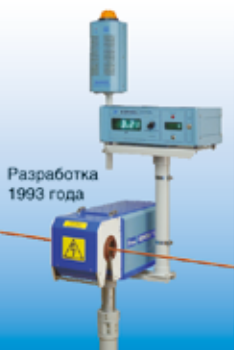
«Корона-1», «Корона-2» Звучающие аппараты сухих испытаний. Синусоида (1,5...2) кГц, (1,5...30) кВ. Диаметр кабеля до 15 мм.
