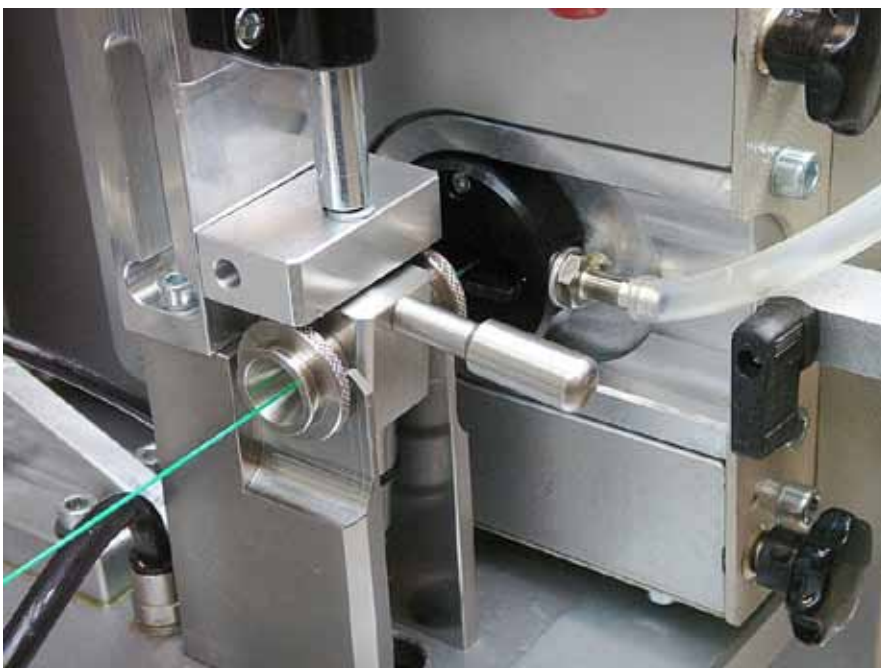
Рис. 1. Головка-аппликатор для нанесения краски
