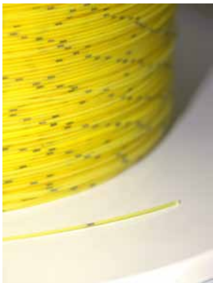
Рис. 2 Окрашенное оптическое волокно
