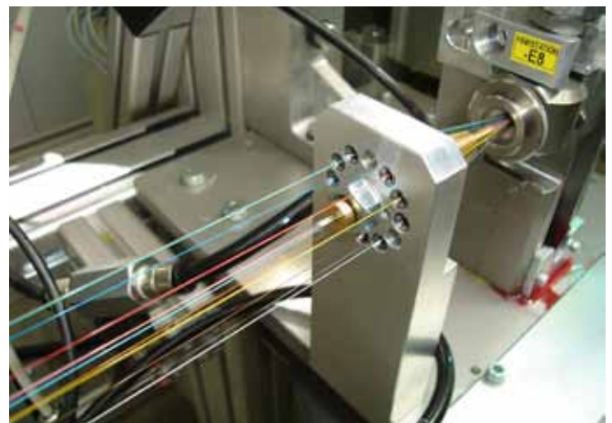
Рис. 10. Головка-аппликатор для нанесения покрытия на компактный блок из 12 волокон
