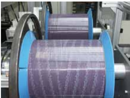
Рис. 6. Сдвоенное приемное устройство для волоконно-оптической ленты
