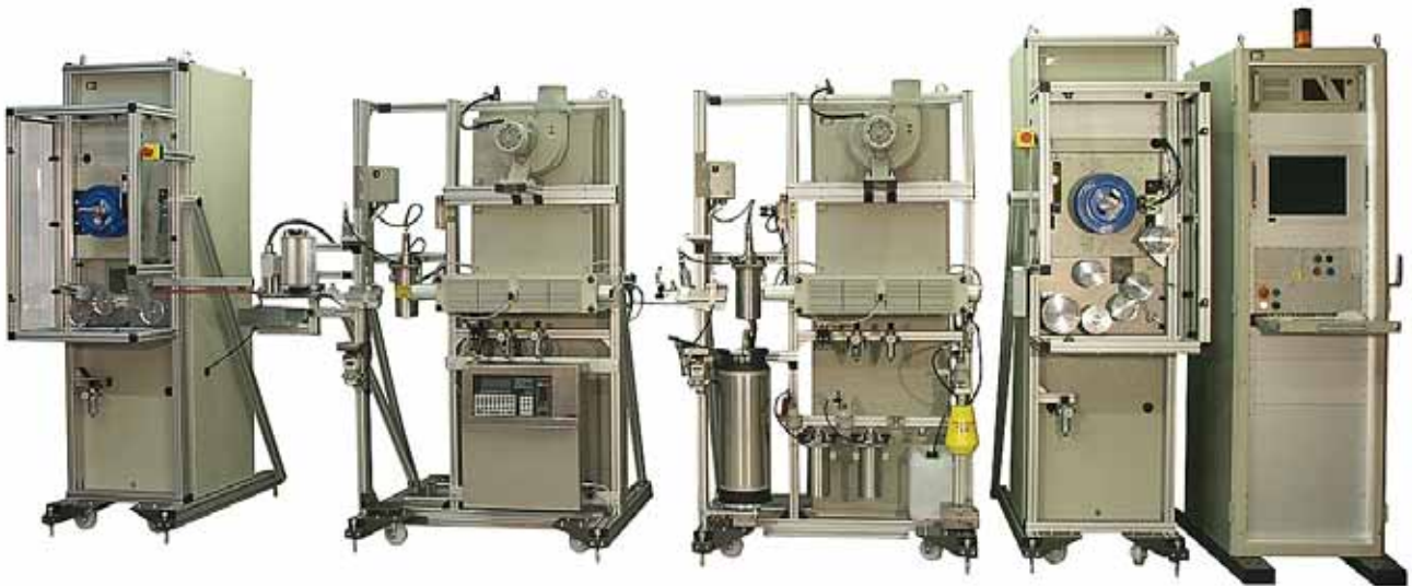
Рис. 11. Линия для окраски и кольцевой маркировки оптического волокна
